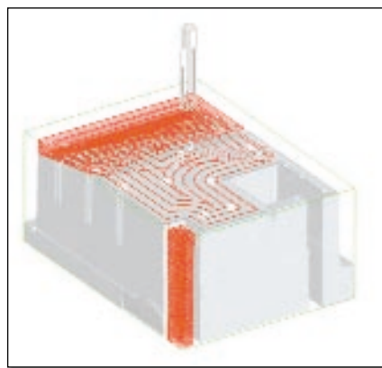
NC-Simulation bei der Herstellung eines Spritzgusswerkzeugs.
